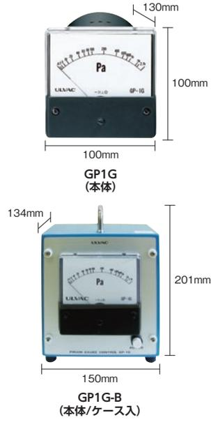
**特長** ●コストパフォーマンス抜群です。●気体の熱伝導を利用した定温度型ピラニ真空計です。●低真空領域(0.4~2700Pa)の測定が可能です。●フィラメントには耐久性に富んだ白金を採用しています。●測定子は互換性があります。●JCSS校正も可能です。
