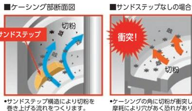
●サンドステップ構造により切粉を巻き上げる流れをつくりやす。
